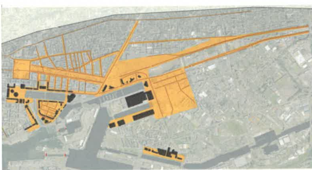
Figure 55: Bâti représenté comme obstacle à l'écoulement (en noir) et lignes de contraintes représentant les axes de circulation (en marron)
